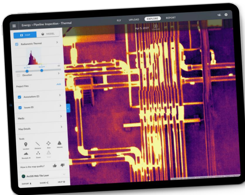
Figure 2. L'imagerie thermique des itinéraires des pipelines révèle des points chauds, qui peuvent indiquer des défauts potentiels dans l'isolation des pipelines ou des fuites invisibles à l'œil humain.
